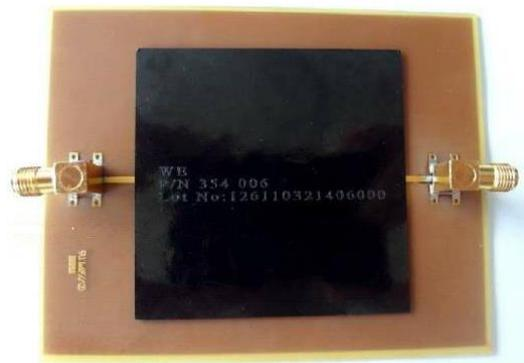
图 7：带有微带线的测试装置
