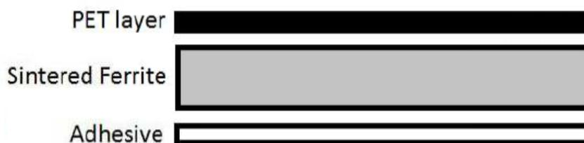
图 2：WE-FSFS 片的构造
