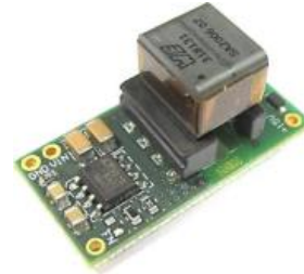
图5: 用于高压SiC/GaN/IGBT栅极驱动的紧凑、隔离的DC/DC转换器参考设计
