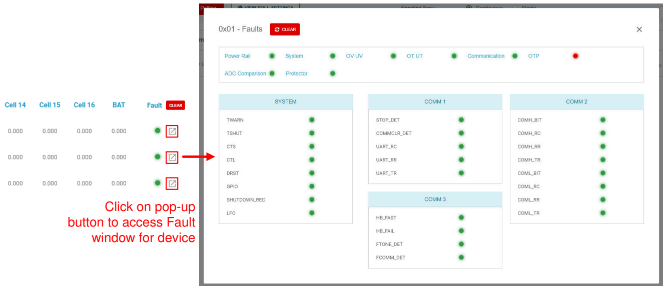
图 3-3. 电池监控页面中的器件故障显示
