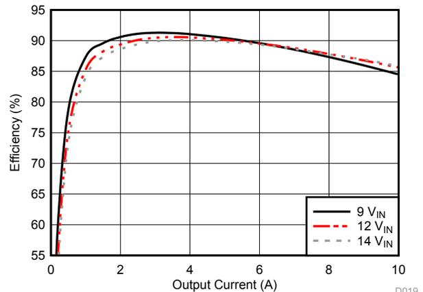
1.8 V<sub>OUT</sub>, 2MHz (每相位), 外部 VG+, 3.2mm x 2.5mm x 1.2mm 电感
