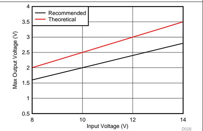
图 24. Max Output Voltage vs Input Voltage
