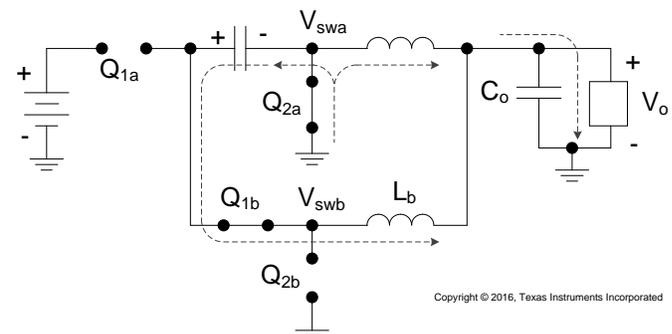
图 45. Phase B High Side MOSFET On
