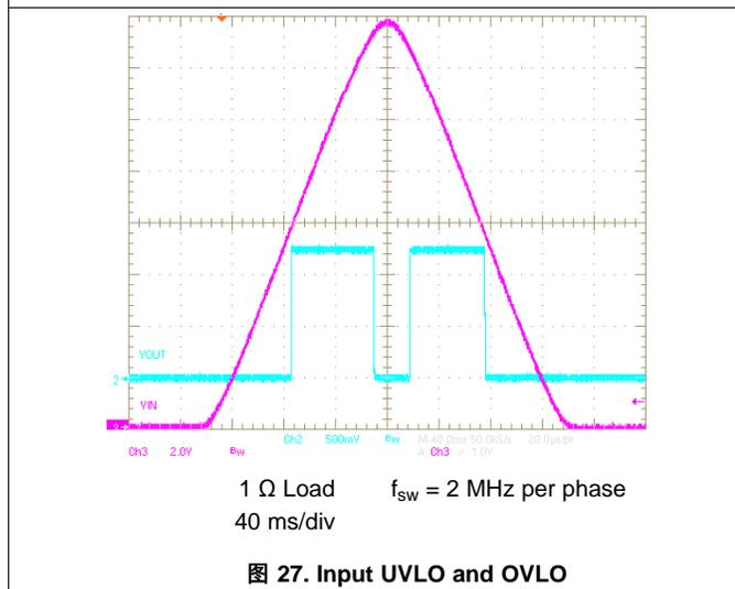
图 27. Input UVLO and OVLO
