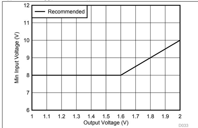
图 25. Min Input Voltage vs Output Voltage
