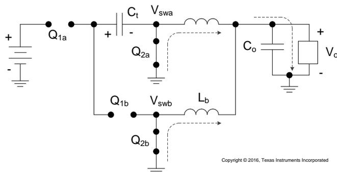
图 46. Phase A/B Low Side MOSFET On
