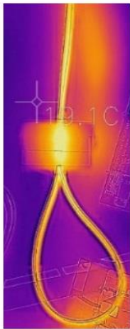
图 4: 环境温度 19.1^{\circ}\text{C} 下的 TBL 电流过载测试
