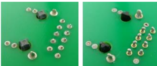
图 3：不同引脚长度的焊接比较
