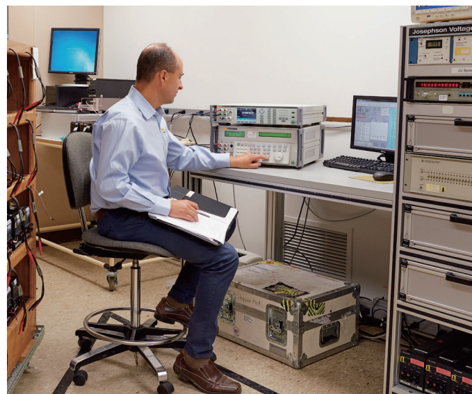
交流电压测量设置
