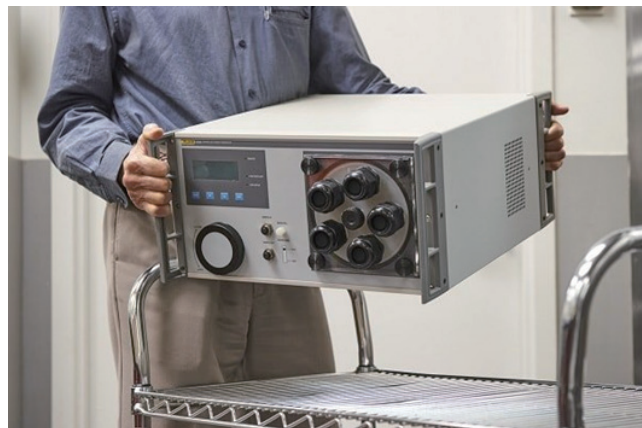
校准技术人员演示Fluke 5128A湿度发生器校准器的便携性
