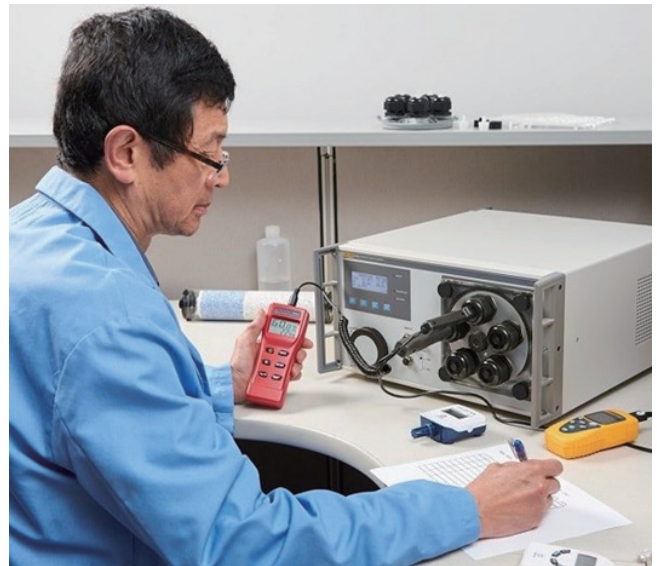
技术人员正在利用Fluke 5128A湿度发生器/校准器校准湿度传感器
