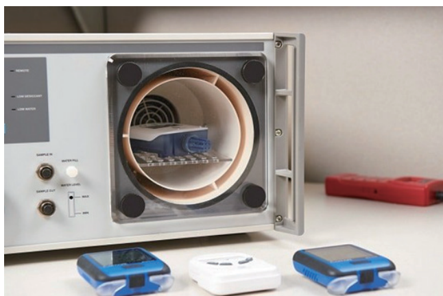
在Fluke 5128A湿度发生器/校准器内进行校准的湿度传感器
