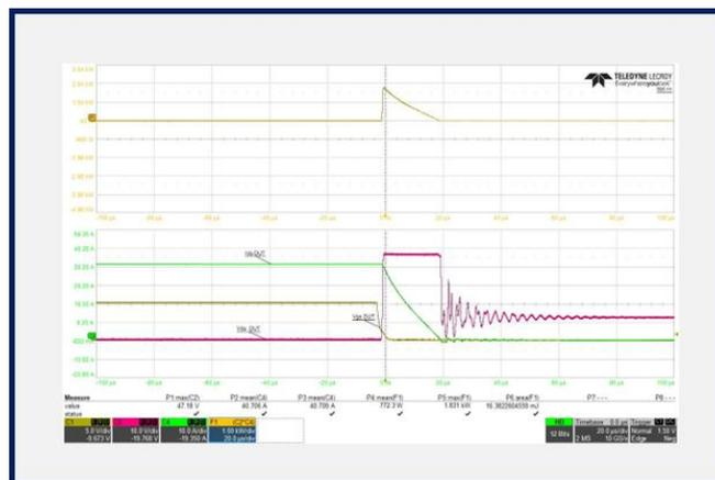
图 10. MOSFET 雪崩耐量基准测试
