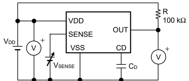
图27 检测响应时间的测定电路
