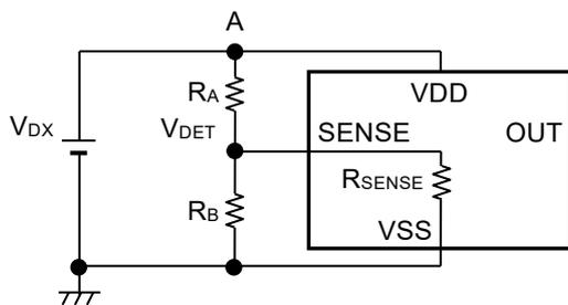
图18 检测电压外部设定电路
