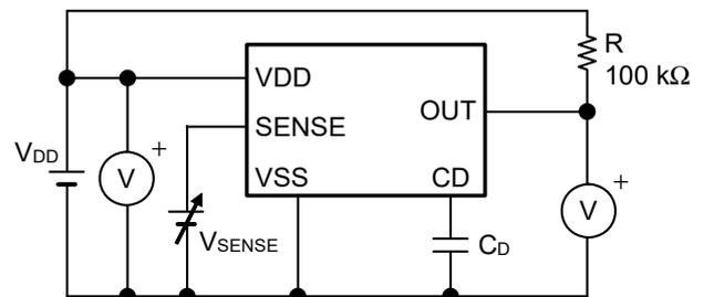
图29 解除延迟时间的测定电路
