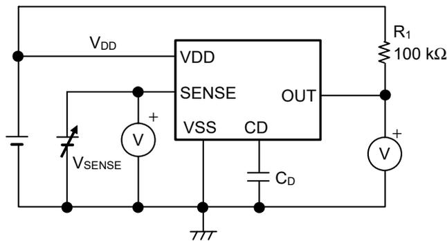
图13 检测电压、解除电压的测定电路
