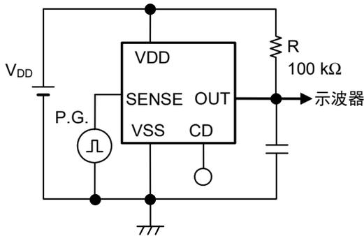
图31 响应时间的测定电路 (N沟道开路漏极输出产品)
