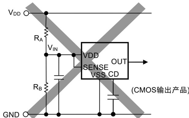
图19 检测电压改变电路不良事例
