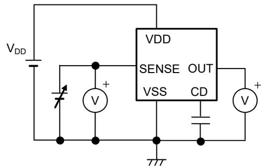
图17 检测电压、解除电压的测定电路
