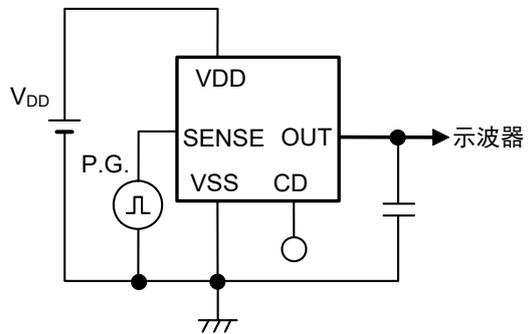
图32 响应时间的测定电路 (CMOS输出产品)
