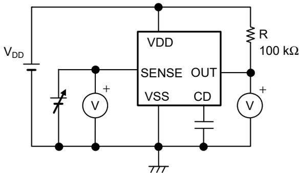
图16 检测电压、解除电压的测定电路
