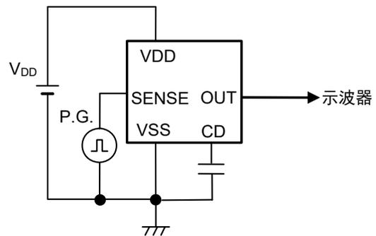
图10 测定电路4 (CMOS输出产品)
