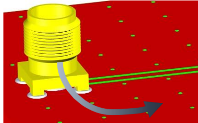
图 19: 信号路径: 连接器连接 PCB 走线
