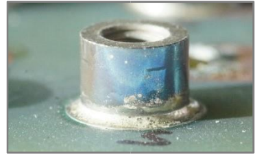
焊接结果：不正确的镀层
