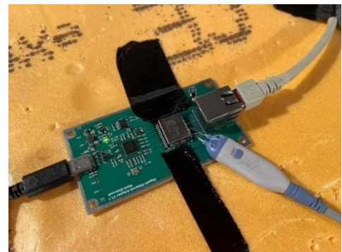
图6: 上图: 变压器和 RJ45 之间以太网信号的线路代码; 下图: 测量设置
