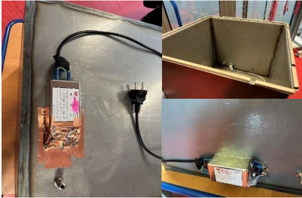
图9: 用于减少辅助设备干扰的屏蔽箱。230V 交流电源通过馈入口的两级滤波器进入屏蔽箱。屏蔽电缆通过屏蔽馈入件连接到封装接地，箱盖采用射频密封，防止电磁辐射通过开口进入。
