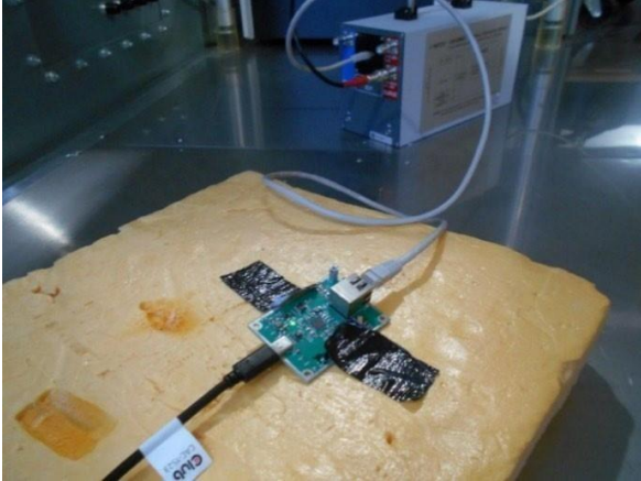
图 34: 使用CNI 508N2 CDN对非屏蔽以太网电缆进行浪涌耦合
