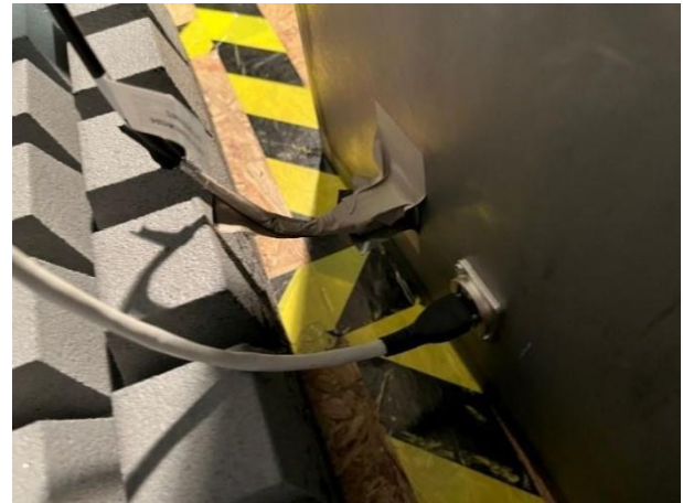
图10: 上图: 采用“猪尾巴设计”的USB 插头屏蔽连接缺陷的X射线图。这种连接方式降低了屏蔽编织的效果; 下图: 使用屏蔽带连接USB电缆屏蔽层, 改善USB 插头的猪尾巴设计。
